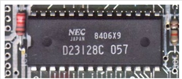
PROM D23128C en la placa de una Sinclair ZX Spectrum.
